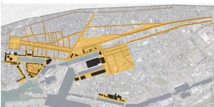
Bâti représenté comme obstacle à l'écoulement (en noir) et lignes de contraintes représentant les axes de circulation (en marron)
